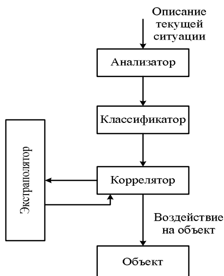
Рис. 1. Структура системы ситуационного управления
