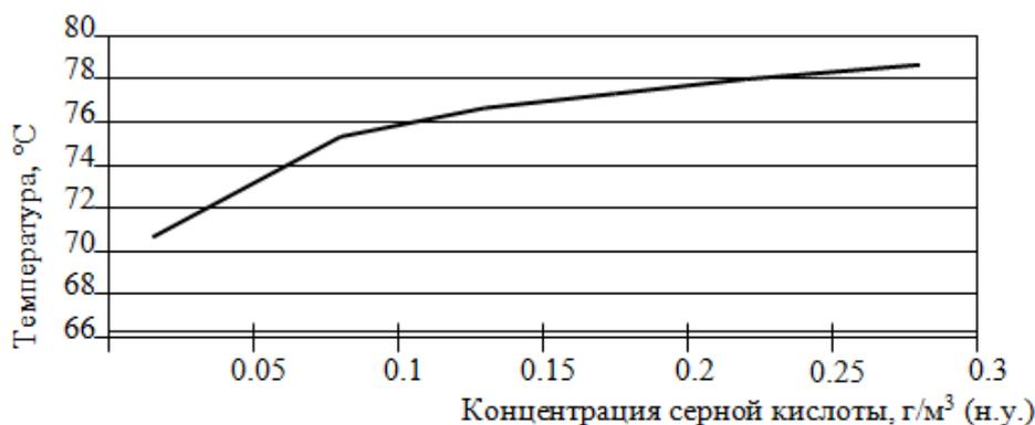
Рис. 1. Зависимость концентрации серной кислоты в отходящих газах на входе в санитарную трубу от температуры в сушильной башне
