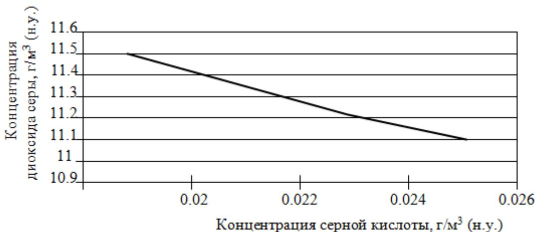
Рис. 3. Взаимосвязь между концентрацией серной кислоты и диоксида серы в отходящих газах на входе в санитарную трубу
