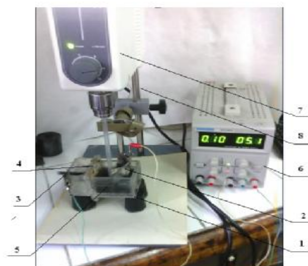
1- электролизная ячейка; 2- гофрированный катод из нержавеющей стали; 3- графитовый анод; 4- катионитовая мембрана МК-40; 5- винт; 6- Выпрямитель (источник постоянного тока); 7- мешалка; 8- штатив
